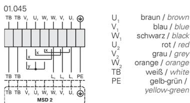
x Brücke für hohe Drehzahl / bridge for high speed
